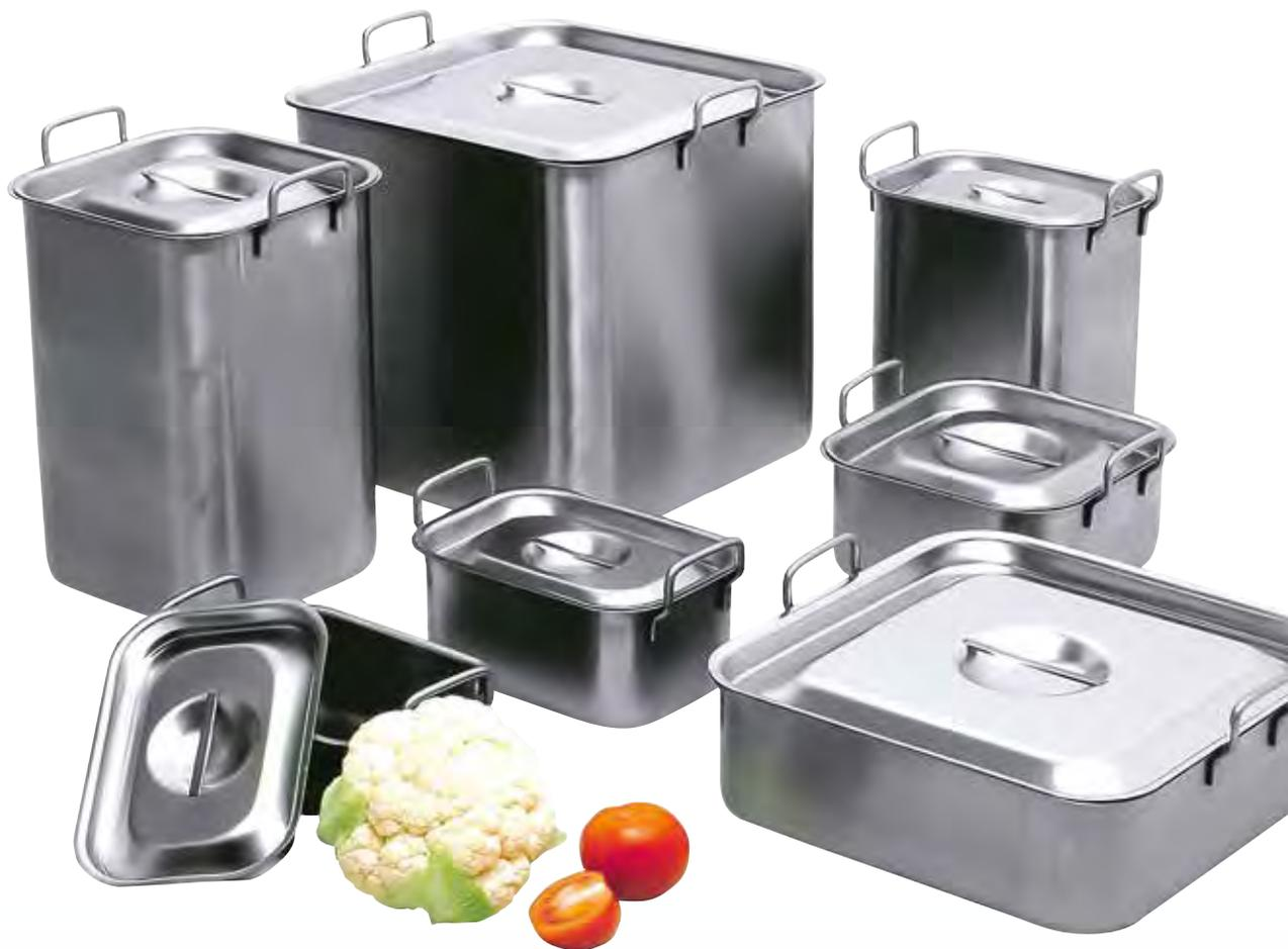
Die ABC-Schalen werden in hoher Qualität aus rostfreiem 18/8-Stahl hergestellt, dessen Oberfläche aufgrund der elektrolytischen Politur so fein ist, dass sie hohen hygienischen Anforderungen gerecht wird. Sie erfüllen die europäische Norm EN 631 für Materialanforderungen beim Umgang mit Lebensmitteln. Aufgrund der Plattenstärke von 0,8-1 mm ist eine lange Lebensdauer gewährleistet.
